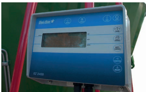
Дисплей для контроля веса компонентов корма и времени работы
