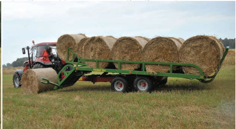
Широкая грузовая платформа (2250мм) позволяет загружать рулоны в два ряда.
