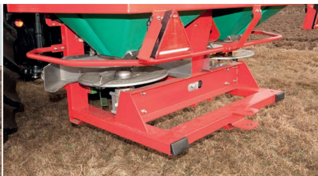
Разбрасывающие тарелки из кислотоустойчивой стали, устойчивы к коррозии
