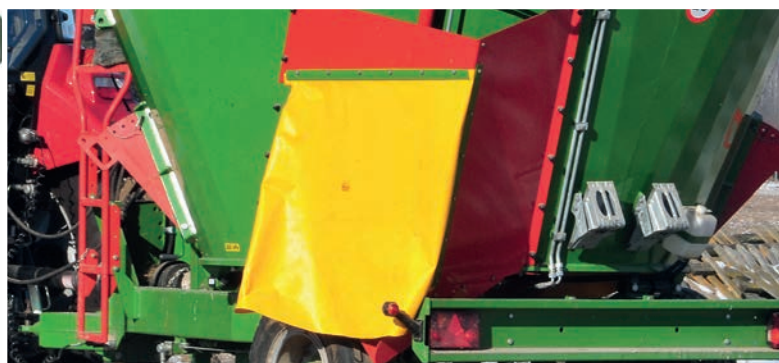
VMP-10S – выгрузочные окна с лотками и защитой
