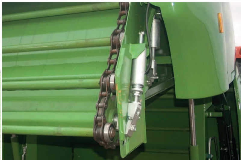
Сворачивающаяся цепь позволяет на сбор пересушенного и влажного материала.
