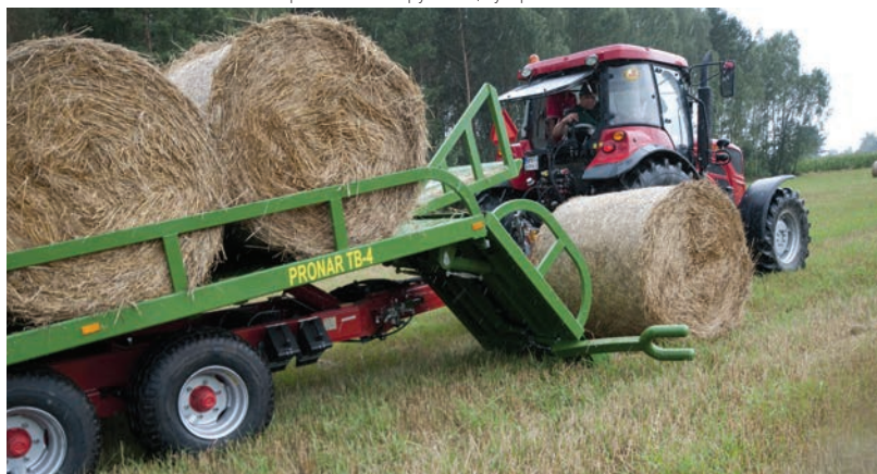
PRONAR TB-4 - Собирательно - загружающее устройство
